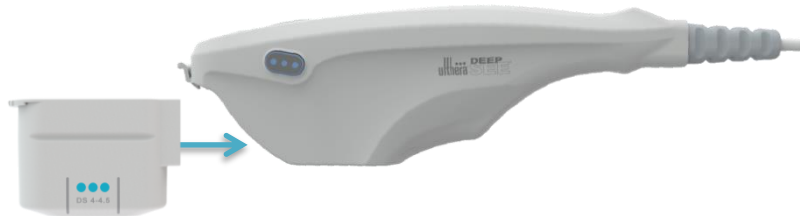
Figura 7.7 - Conexión del Transductor
